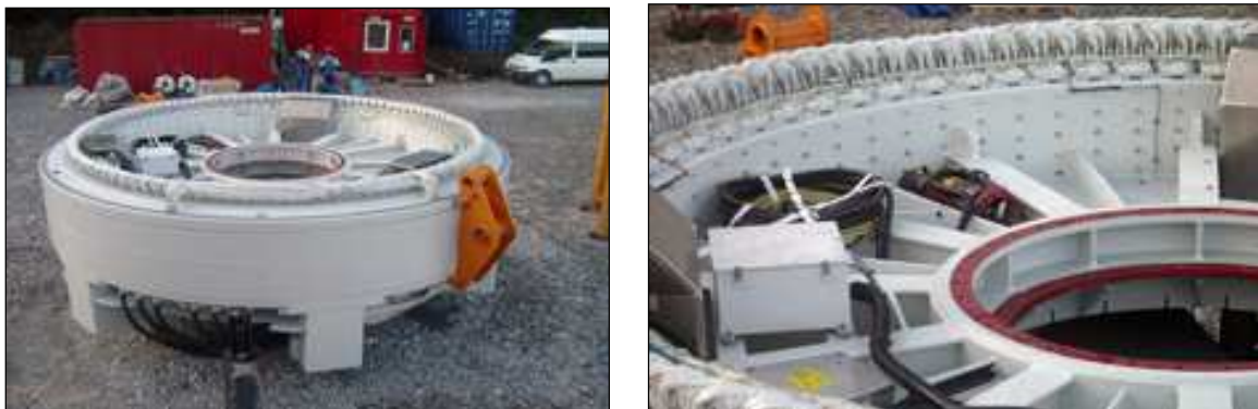
Figure 23 : Générateur annulaire – Source : Enercon/Grennelec
